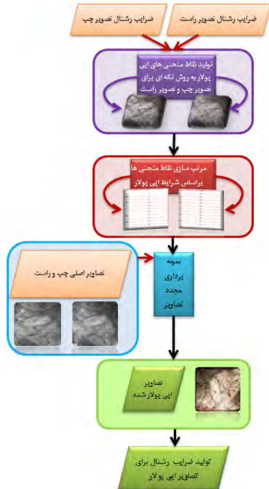
شکل ۴- تولید منحنی اپی پولار به روش تکه ای و تولید تصاویر اپی پولار با استفاده از ضرایب رشنال
