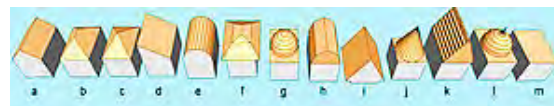
شکل ۶- برخی از انواع متداول بام (a) Gabled- (b) hipped roof- (c) pyramidal- (d) shed- (e) round- (f) mansard- (g) dome- (h) gambrel - (i) A frame- (j) conical - (k) Crow-stepped gable- (l) onion- (m) flat
