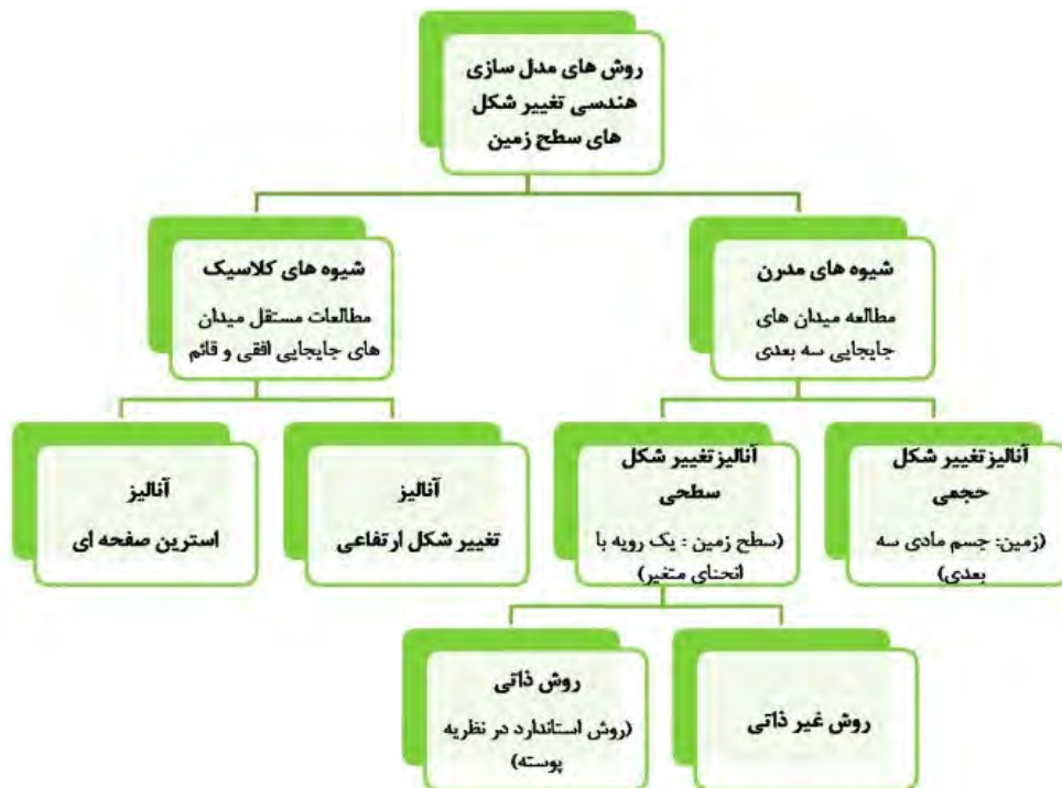
شکل ۳- روش‌های مدل‌سازی هندسی تغییر شکل‌های سطح زمین (و ثوقی [۳])
