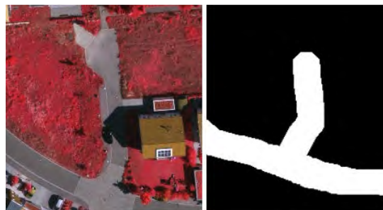
شکل ۱۶- تصویر یک نمونه راه فرعی اشتباه استخراج شده
