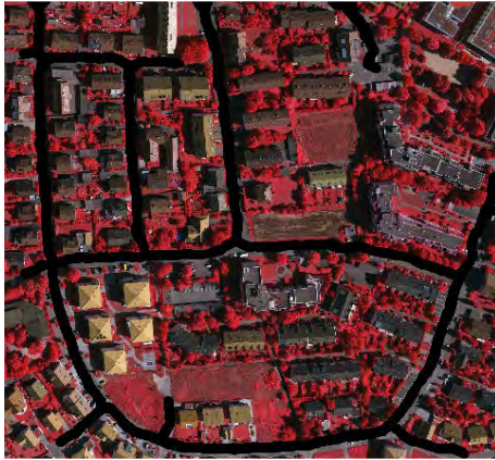
شکل ۱۴- راه‌های استخراج شده توسط روند پیشنهادی بر روی تصویر هوایی منطقه با ترکیب رنگ کاذب
